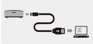
**NOTA:** Verifique se que a unidade toque já tem sido alternada para o modo de alinhamento (etapa 1) antes de conectar o cabo USB do projetor ao computador para evitar interferência ou indesejado toque aciona durante a instalação pela primeira vez, prévia calibração adequada.
